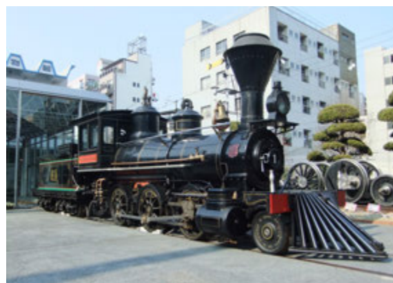
図3：カウキャッチャー 蒸気機関車(義経号として復元された国鉄7100形蒸気機関車7105)の前部に取り付けられた金属性金属カウキャッチャーが確認できる ※15 。
