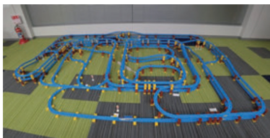
図12：プラレールを利用した半加算器の全体像 流れはプラレールの鉄道車両模型を使用し、スイッチはポイントを使用しているのが見いだせる ※20 。
