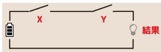
図2：論理和演算の電気回路での表現 スイッチがXとYとで2つある。そして、両方ともスイッチがONにならないと結果の部分に電気が行き着くことなく、明かりが付くことはない。どちらか片方だけスイッチがONになれば結果は0、両方ともスイッチがONになったときだけ結果は1となる。これによって論理和演算が電気のON/OFFによって実現できている ※11 。
