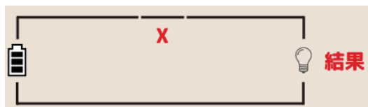
図4：論理否定演算の電気回路での表現 論理否定演算は、命題が真の場合は結果が偽、命題が偽の場合は結果が真と逆の値を出す演算である。この場合、スイッチがOFFの状態では電気が流れるようになっている *11 。
