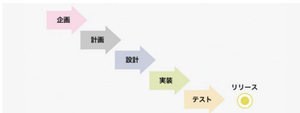
図2：ウォーターフォール開発 開発工程を段階的に完了させていくのがウォーターフォール開発の特徴 *11
