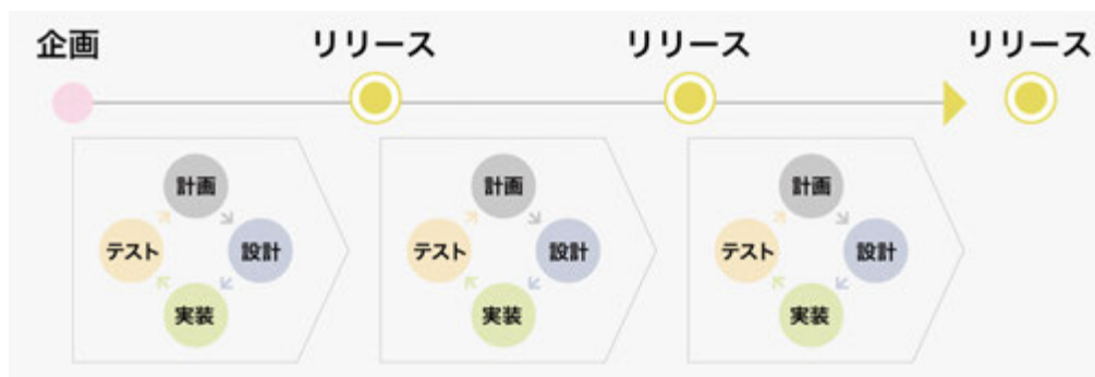
図1：アジャイル開発 開発工程を機能単位の小さいサイクルで繰り返すのがアジャイル開発の特徴 *11
