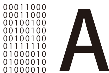
図2：ビットマップフォントの2進数化 ※2
