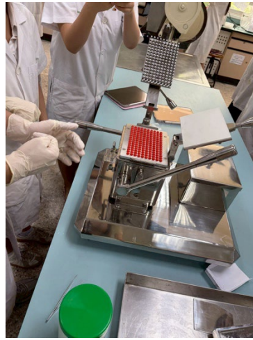
カプセルに薬剤を充填する機械
