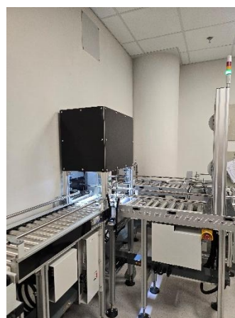
各階をつなぐ薬剤運搬用 コンベアシステム
