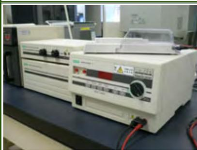
専用キュベット内の細胞浮遊液に有用遺伝子を入れ、そこに高圧パルスを与え一時的に細胞膜に小さな穴をあげ遺伝子を導入させる装置。キュベットは 0.4, 0.2, 0.1 cm の 3 種類。キュベットは事務室で用意しています。
