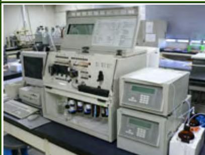
たんぱく質のアミノ酸の配列の決定および同定を行う。キャリブレーションされたスタンダードサイクルのピークと残基サイクルのピークとを比較した結果からアミノ酸ピークを同定。各残基サイクルに専用アルゴリズムを適用、シーケンスを決定する。
