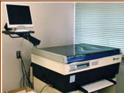
H3, C14, P32, P33, S35 など  $\beta$  線を出すアイソトープの測定に使用する。バイアル瓶に入れる有機カクテルはユーザーが準備して下さい。
