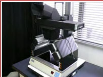
254nm, 364nm 落射照明、312nm 透過。ポラロイド写真撮影装置。
