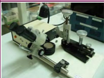
先端径  $0.1\mu\text{m}$  以下のイントラ用ガラス電極から、 $50\mu\text{m}$  以上の特殊インジェクション・ピペットまで、非常に幅広い形状のマイクロピペットを研磨することができる。
