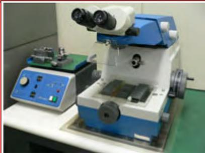
透過電子顕微鏡の試料前処理装置のひとつで超薄切片を作製する装置。
