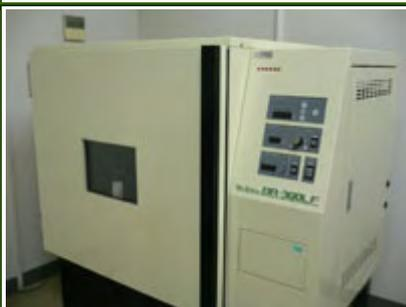
使用温度:4~70°C、振とう速度:25~250rpm
