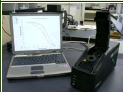
融解曲線分析法を用い、遺伝子の変異・SNP を短時間(1 検体当たり 30~120 秒)かつ高感度で解析(スキャン)を可能。変異解析専用として開発された蛍光色素 LC Green I を用い、高額な標識プローブを使わずに研究が実現できる装置。
