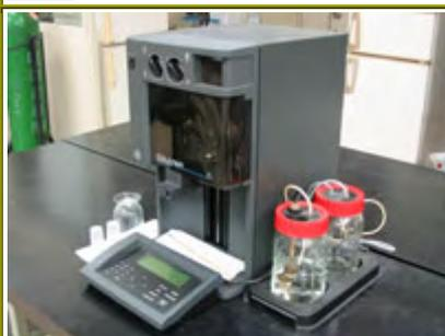
電解液(希釈液)内に浮遊している粒子あるいは細胞が小さな孔を通過する際に生じる電気抵抗の変化を検知し測定する。アパーチャサイズ 100 $\mu$ m 粒径範囲 2 ~ 60 $\mu$ m 吸引量 0.5ml
