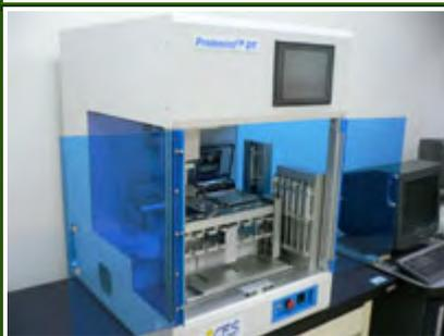
転写、翻訳、精製(精製率約 70%)まで全自動で行う。1 ウェルあたり精製前約 0.5mg(GFP の場合)の合成能有し、一昼夜で 6 ウェル同時に合成。
