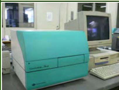
マルチプレート対応の高性能蛍光測定装置。分注機を 1 台装備し、回転攪拌機能やインキュベーターを内蔵しているので、ルシフェラーゼアッセイからセルカウティングまで様々な蛍光測定が可能。測定機能: 蛍光。感度: 1fmol ATP / well 以下。波長範囲: 270~670nm。対応プレート 1~384 ウェルプレート。インキュベーター(室温 +3℃ ~ 45℃)
