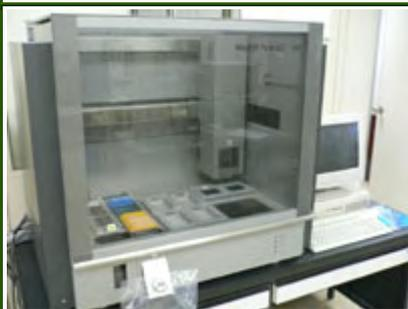
磁性体粒子テクノロジーにより 1 ランで最大 32 サンプルまでの核酸( DNA 、 トータル DNA 、 トータル核酸)を 90 分以内で高品質に抽出可能。
