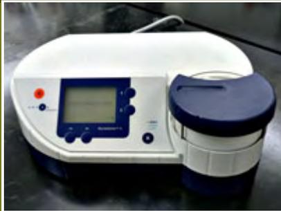
エレクトロポレーション法を応用し、導入装置と専用試薬を使用して、遺伝子導入の困難なプライマリー細胞や株化細胞でも高い導入効率を得られます。
