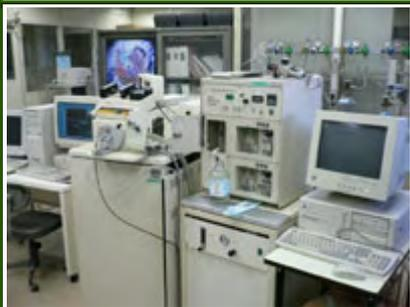
蛋白質・核酸などの生体高分子化合物の構造解析を行う分析機器であり、その化合物がもつ分子量を 0.01 %の精度で決定出来る。エレクトロ(ナノ)スプレーイオン化により化合物をイオン化し検出する。通常は高速液体クロマトと連結して使用する。
