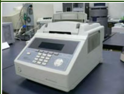
DNA の変性、結合、伸長の三つの反応を 30~40 サイクル繰り返すことで特定の塩基配列を増幅させる装置。
