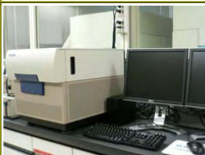
96 ウェルプレートなどから高速に蛍光画像データを取得し(96well/3min)、画像解析を行うことで様々なデータを出力する。
