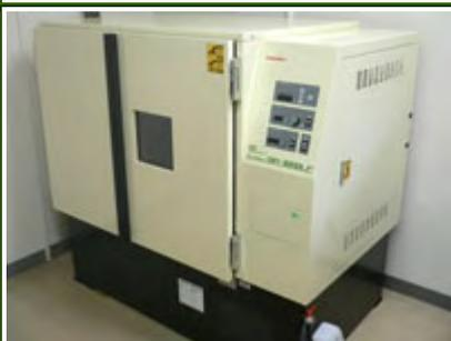
使用温度:4~70°C、振とう速度:25~250rpm
