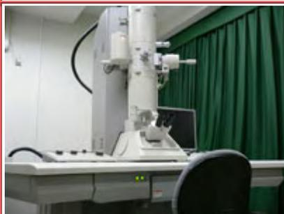
高感度高精細デジタルカメラ(100 万画素)を搭載した透過電子顕微鏡。高コントラスト、かつ少ない電子線量での像観察が可能。画像解析、画像処理、自動粒子検索システムソフトを搭載。3 個試料ホルダ、試料回転ホルダ、高分解能二軸傾斜ホルダを装備。分解能: 0.2nm (格子像) / 0.36nm (粒子像)、加速電圧: 40 ~ 120kV、倍率: 50 ~ 600,000 倍。
