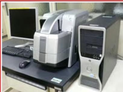
暗室不要のオールインワン蛍光・位相差・明視野倒立電動顕微鏡
