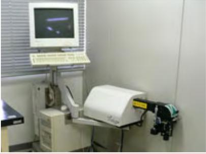
皮膚表面から波長 830nm の近赤外線レーザーの組織深部到達作用と共焦点走査法を利用してから毛細血管の血球の観察が出来る。
