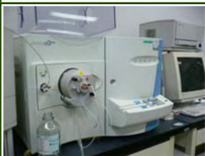
蛋白質・核酸などの生体高分子化合物の構造解析を行う分析機器である。その特色として、全自動で高分子化合物の検出及びその構造解析を同時に実施出来る。
