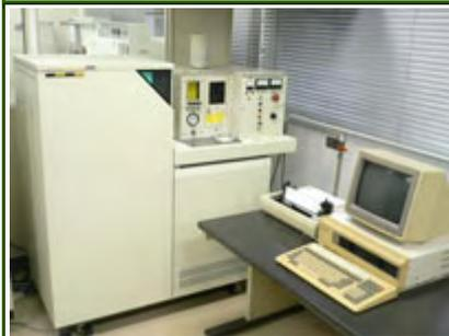
190～900nm の波長範囲における金属成分の発光分析に用いる。発光部であるプラズマが高温なため化学干渉が少なくダイナミックレンジが広い。そのため迅速に多元素定量、定性分析が行える。また付属の超音波ネブライザーを用いると検出限界を 1/5～1/10 に改善できる。アルゴンガス使用。
