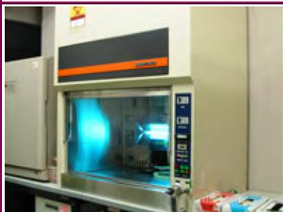
HEPA フィルターで濾過した排気を行うことにより作業台内を負圧に保ち、実験操作中に発生するエアロゾルが外部へ拡散しない。
