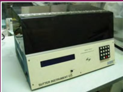
微小ガラス針を作製する装置。ICSI 用ニードル作製用プログラム、ホールディングピペット作製プログラム標準装備
