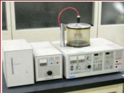
走査電子顕微鏡用試料への導電性薄膜コーティング処理に使用する。おもに Pt-Pd(合金)2~15nm 程度のコーティングに使用。
