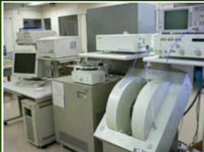
不対電子( unpaired electron )を測定対象として、これらのイオンを含むタンパクや、生体由来の金属酵素の構造、酵素の一部が生体内で作り出す活性酸素などを解析可能。
