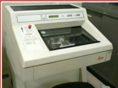
凍結標本の薄切に用いられる。厚さ 0.5~60  $\mu\text{m}$  の切片作製が可能。
