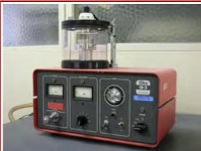
真空中で気体放電の際に気体イオンが固体物質に衝突して構成原子たたき出す現象を応用し走査電子顕微鏡用試料の導体化コーティングを行う装置。
