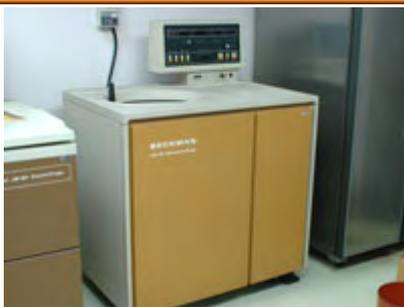
回転数: 1,000rpm ~ 70,000rpm
