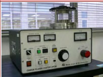
走査電子顕微鏡の試料表面の新しい金属被膜法。強い電子線照射をしても試料表面帯電、熱ダメージ、コンタミネーションがなく、超高倍率で検鏡しても粒子性は見られず分解能限界まで観察が可能である。オスmium導電被膜をした試料側を溶解除去して被膜だけを透過電顕で金属膜の一段レプリカとして透過立体像が観察できる。
