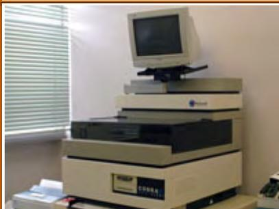
I125, Cr51 など  $\gamma$ (X)線を出すアイソトープの測定に使用する。測定用のチューブはユーザーで準備する。
