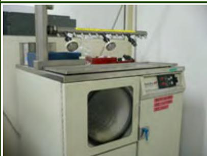
凍結した試料を減圧真空中におき試料から水分を昇華させ乾燥させる装置。-84 °C、50mTorr 以下。
