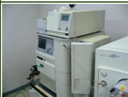
オートサンプラー付きの高速液体クロマト計であり、質量分析計とオンラインで連結できる。
