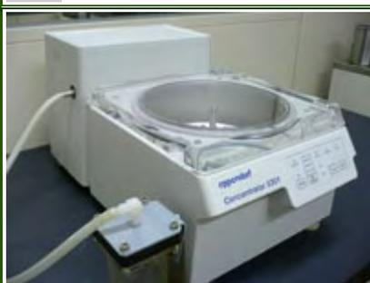
エッペンドルフ、その他のサンプリングチューブ中の試料に遠心力をかけながら減圧状態で溶媒を蒸発させサンプルの濃縮を効率よく行う装置。
