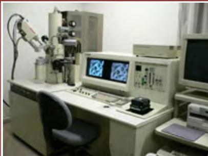
電子線が試料表面を照射し、スポットを走査させることにより発生した二次電子や反射電子を検出し拡大像として記録する。デジタル撮影装置
