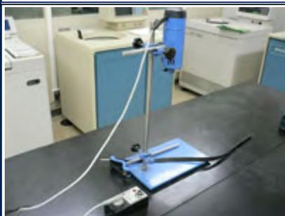
細胞破砕器。刃先外径 18mm, 10mm
