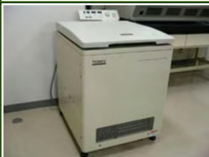
TS-402B/max4,500rpm マイクロプレート×2 枚
