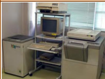
IP(イメージングプレート)を用いたバイオイメージング解析システムです。UNIX マシンでコントロールしています。IP は各ユーザーで購入して下さい。
