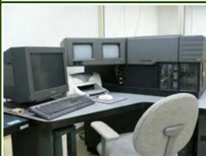
細胞などの粒子 1 個ずつから大きさ形態、ならびに DNA 蛍光染色やタンパクなどを蛍光抗体で染色した蛍光の情報を高速度で取得し、それらの相関を解析する。さらに目的とする 2 種類の細胞群を高速(3,000event/sec)で分取することができる。
