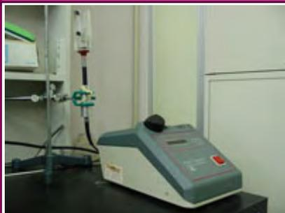
微量遠心チューブ、96 穴マイクロプレートなどの少量の容器において、超音波処理を行うための装置。片手に発振用コンバーターを持ちながら作業することができる。
