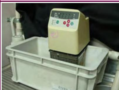
温度調節範囲: 室温 +5 ~ 80 $^{\circ}$ C (付属バス使用時は 70 $^{\circ}$ C)
