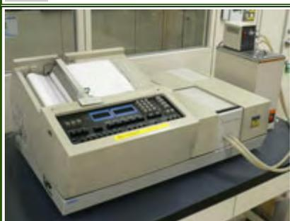
吸光度測定、透過率、シングルビーム測定が可能。測定波長範囲 180~900nm、オートスキャン。
