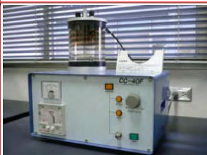
カーボンファイバーという、ひも状のカーボンを取付、カーボン蒸着を簡便に行う装置。
