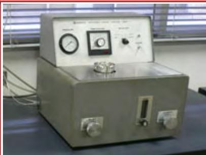
電子顕微鏡の試料をできる限り元の状態に近い形で乾燥する装置。
