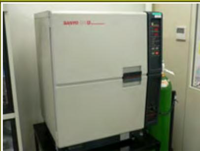
37.0 °C / 炭酸ガス濃度 5% でコントロールしています。
