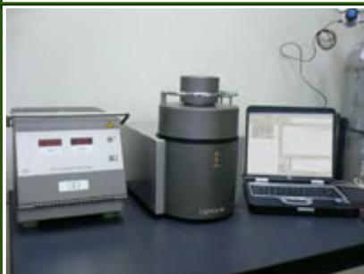
ガラスキャピラリーの使用により、より迅速な加熱と冷却が可能。PCR の結果を短時間で終了すると同時に PCR 産物の増幅をリアルタイムかつオンラインでモニターできる。30~40 サイクルの実行を 20  $\mu$ l のキャピラリーで 30 分、100  $\mu$ l のキャピラリーでは 80 分で行う。
