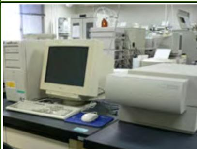
電気泳動ゲルの画像計測に用いる。直接ゲルをスキャニングし濃度、面積と移動距離により定量、自動定性が行われる。
