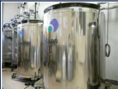
液体窒素自動充填による気相式細胞保存用のタンク(-160℃前後)
