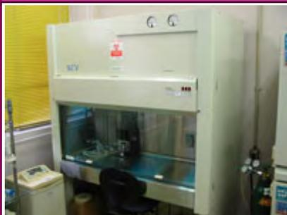
用途: バイオハザード対策を必要とする病原体検査・実験、遺伝子組替え実験等
