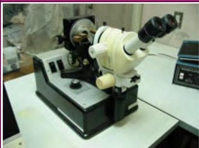
微生物学、物理学などにおいて、顕微鏡下で使用するマイクロツール(微細工具)を作製する装置。材料は比較的低温で加工する。軟質・硬質の各種ガラス類、合金、有機クリスタル、ポリマーなど
