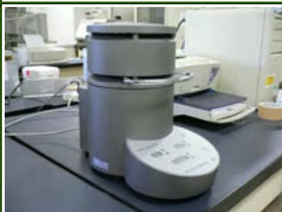
大腸菌ライセート、小麦ライセートによる翻訳を運動させ、無細胞系で鋳型 DNA からタンパク質を合成させることにより、生体や細胞で生合成が困難なタンパク質の合成も可能。CECF 法を採用しており、常に必要量の基質・エネルギー源が連続的に供給、老廃物は即座に希釈されることで効率的な連続合成が可能。
