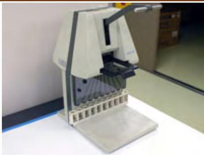
96 ウェルフィルタープレートから液を吸引・ろ過し、その後フィルタープレートを打ち抜く。
