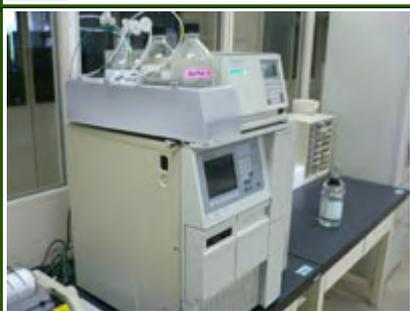
UV 検出計付き高速液体クロマト計であり、生体試料中の多種類の化合物の分離・分取が出来る。
