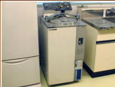
高圧蒸気滅菌器(～ 140 °C、3.5 気圧、60 分)
