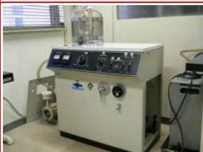
真空中で金属やカーボンを蒸着させる装置。
