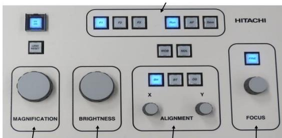
倍率 (Magnification) 明るさ (Brightness) アライメント (Alignment) フォーカス (Focus)
